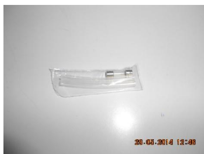
Fusível e Tubos peristálticos
